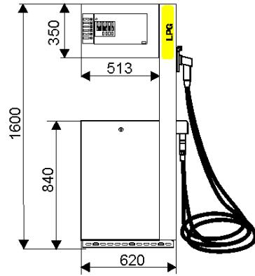
Ширина всех типов раздаточных колонок 410 мм
