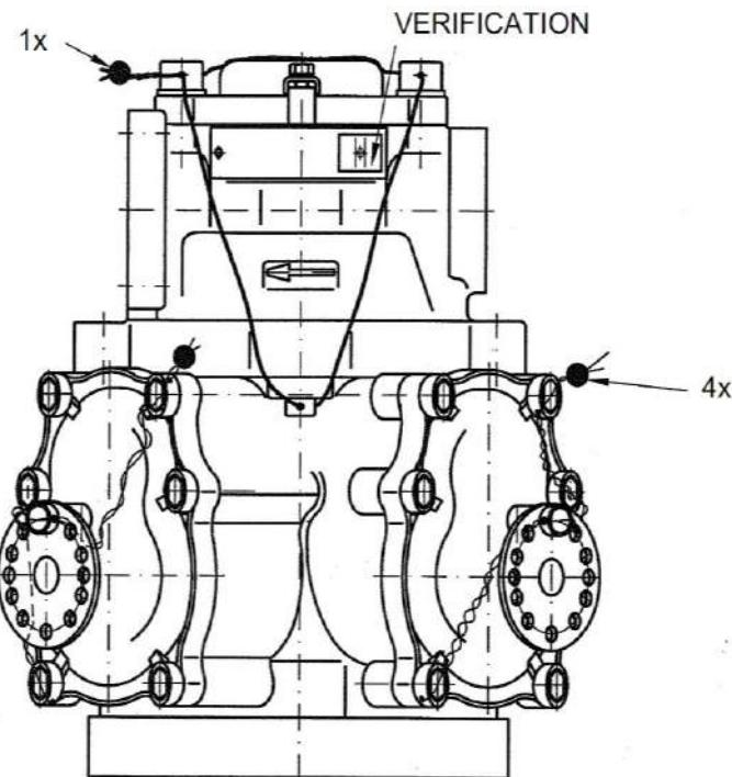
**Схема нанесения оттисков государственного поверительного клейма на расходомер M 406.25P/1 с функцией механической калибровки**
