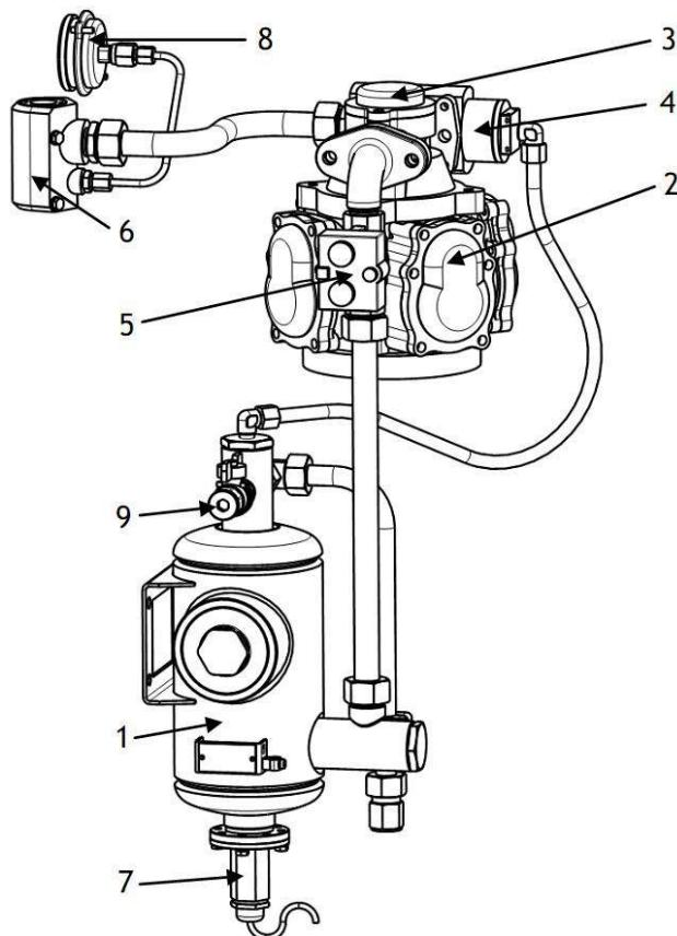
В нижней части раздаточного модуля помещен шаровой кран (в подводящем трубопроводе LPG) и сепаратор с фильтром (поз. 1), который создавает один конструкционный узел с обратным клапаном жидкой фазы, предохранительным клапаном и аварийным клапаном газовой фазы. У ТРК оснащенных температурной коррекцией выданного множества топлива в зависимости от его мгновенной температуры (ATC) в сепараторе введен снизу реостатный датчик температуры LPG (поз. 7).
