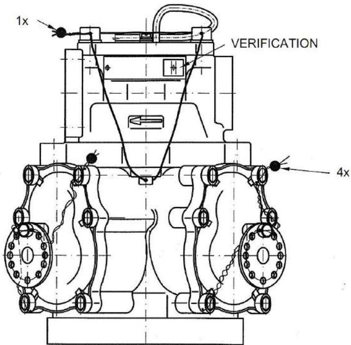
**Схема нанесения оттисков государственного поверительного клейма на расходомер M 406.xxEP с функцией электронной калибровки**
