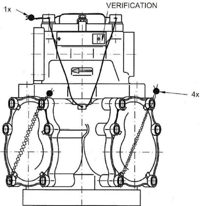
**Схема нанесения оттисков государственного поверительного клейма на расходомер M 406.25EP/1 с функцией электронной калибровки**
